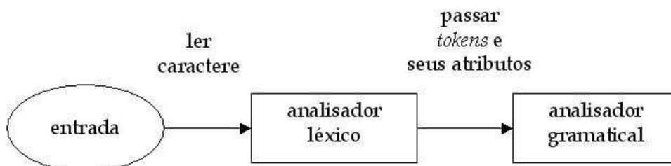
Figura 2.3: Função de um analisador léxico (baseado em [1, p. 25]).
